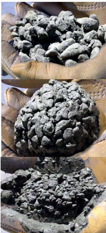
Insuficiente cantidad de agua
